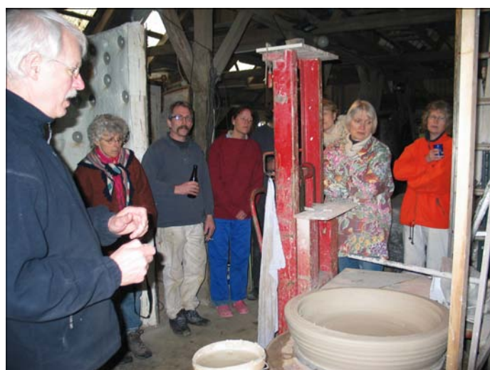
Askel forklarer, hvordan løftevognen og tværstangen fungerer. Bunden til den store krukke havde han forberedt på forhånd. Målepinden ses yderst til venstre i billedet.
